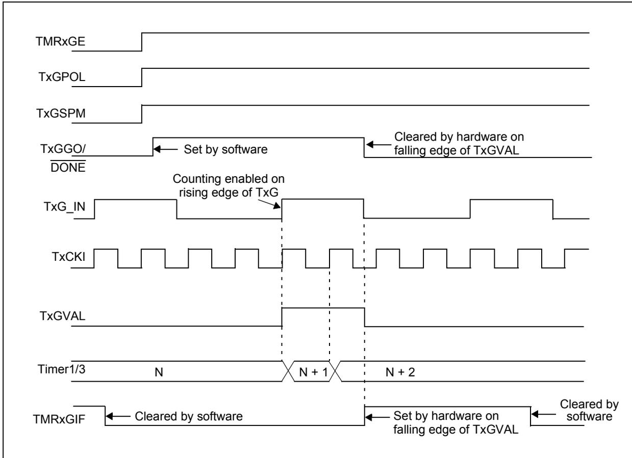
**FIGURE 13-7: TIMER1/3 GATE SINGLE-PULSE AND TOGGLE COMBINED MODE**
