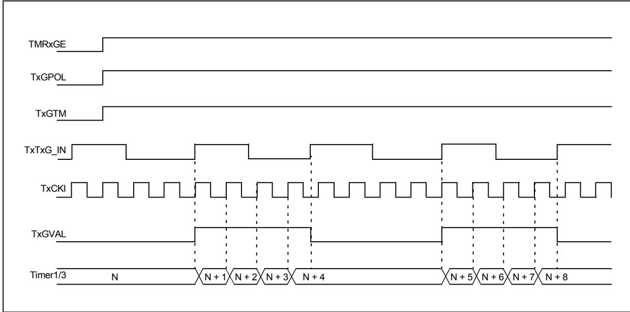
**FIGURE 13-6: TIMER1/3 GATE SINGLE-PULSE MODE**
