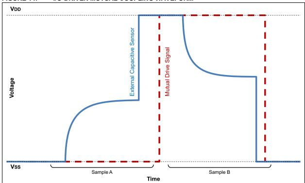
FIGURE 14: I/O-DRIVEN MUTUAL COUPLING WAVEFORM
