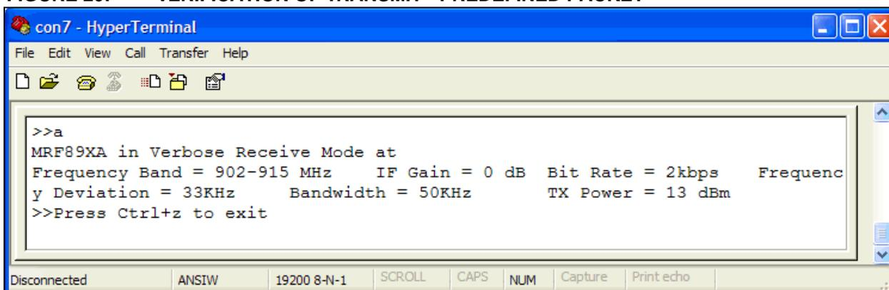
**FIGURE 21: USER DEFINED PACKET TRANSMISSION**
