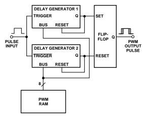
Figure 12. Laser Printer PWM
